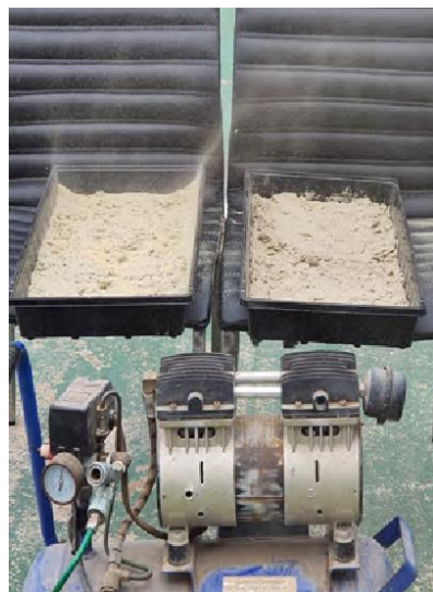
▲ 그린웰 미사용 ▲ 그린웰 사용 (압축기 바람으로 테스트)
